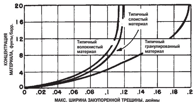
Рис. 12 — Влияние концентрации материалов для борьбы с поглощением бурового раствора при закупоривании трещин.
